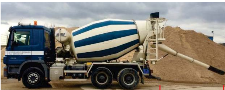
max. Auslasshöhe: ca. 1,70 m Auslasshöhe bei 3 Rinnen: ca. 0,70 m
